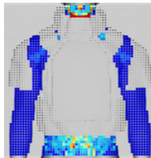
CORE V/L results showing the survival probabilities of a soldier wearing the full BACS configuration. Résultats du CORE-VL représentant les probabilités de survie d'un soldat portant la configuration complète du STAC.
