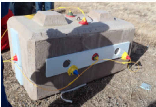
A group MFC and MFC-S emplaced on a concrete block. Ensemble MFC et MFC-S sur un bloc de béton.
