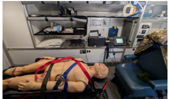
F550 ambulance with accelerometer and mannequin. Ambulance F550 avec accéléromètre et mannequin
