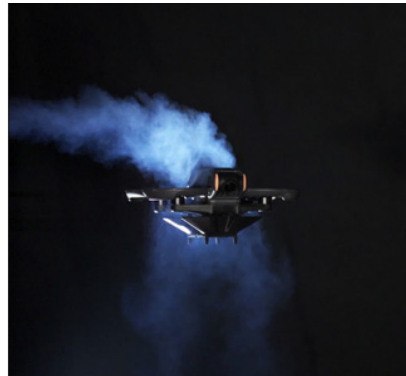
Smoke visualization of rotor-wash and airflow recirculation at DRDC Suffield. Visualisation du sillage des rotors et de la recirculation de l'air à l'aide de fumée à RDDC Suffield
